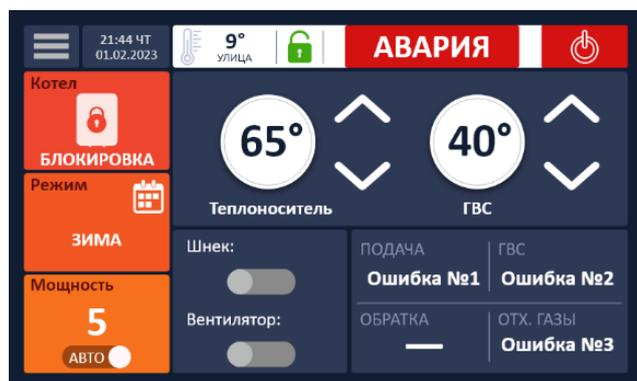
При возникновении любой из ошибок любого датчика температуры (кроме датчика температуры улицы), контроллер переводит котел в состояние остановки. Дальнейшая работа котла возможна после устранения аварии.
