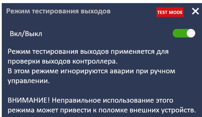
Тестирование выходов осуществляется с помощью элементов экрана **Ручное управление**. Контроллер позволяет протестировать любое из подключенных к нему устройств по принципу «включено / выключено». Однако, если текущий выполняемый алгоритм работы контроллера предполагает нахождение исполнительного устройства во включенном состоянии, то выключить его средствами тестирования будет невозможно.
