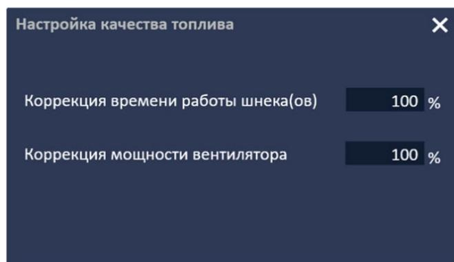
Все коррекции задаются в процентах от используемого контроллером значения для текущих ступеней мощности в автоматическом или ручном режиме работы.
