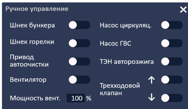
Картинка соответствует максимальному количеству исполнительных устройств. При активации флажка
